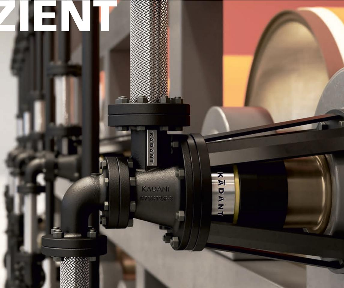
Das Dichtungspaket ist durch ein Edelstahlgehäuse geschützt, um lebensverkürzende Verunreinigungen der Drehdurchführung zu verhindern. Mithilfe der gut sichtbaren Verschleißanzeige für den Dichtring wird eine planbare Wartung möglich.
